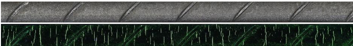
Abbildung 4.4c: Spanndraht mit signifikanten Anrissen, oben: ohne UV- Licht, unten: mit UV-Licht
