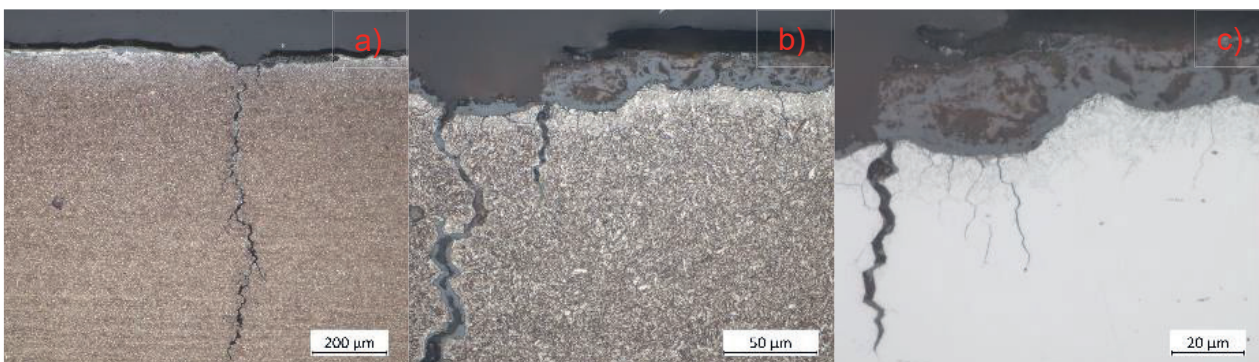
Abbildung 4.4f: Metallografische Längsschliffe a und b geätzt mit Vergütungsgefüge und Anriss, c ungeätzt
