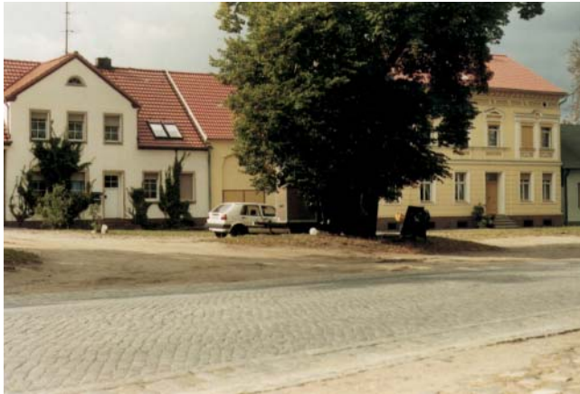
Die Ortsdurchfahrt ist integraler Bestandteil des Straßenraums. Umbaubedarf besteht nur im Fahrbahnbereich; bei einem evtl. Ersatz des Pflasters durch Asphalt (Lärmschutz) sollten die Seitenräume und die weichen Übergänge erhalten bleiben (Jüterbog-Neumarkt).
