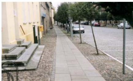
Kostengünstige Variante mit regionaler Identität: Betonplatten zwischen Lesestein (Wusterhausen). Im Gegensatz zu Berlin werden in Brandenburg die Plattenreihen parallel zur Straßenachse verlegt. An Überfahrten sind Tragschicht und Plattenstärke belastbar zu wählen.
