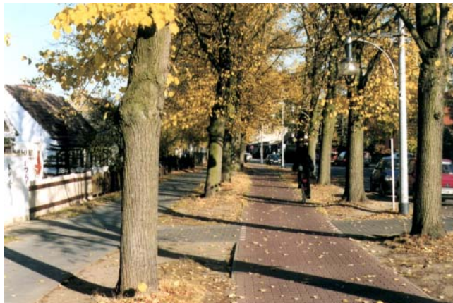
Bei Doppelreihen von Bäumen im Seitenraum können Radweg- oder Gehweg-Alleen neben der Fahrbahn gebildet werden. Derartige stark strukturierte Formen wirken allerdings städtisch und sind eher im Umfeld von Berlin geeignet (hier z. B. Bergholz-Rehbrücke L 78/79).
