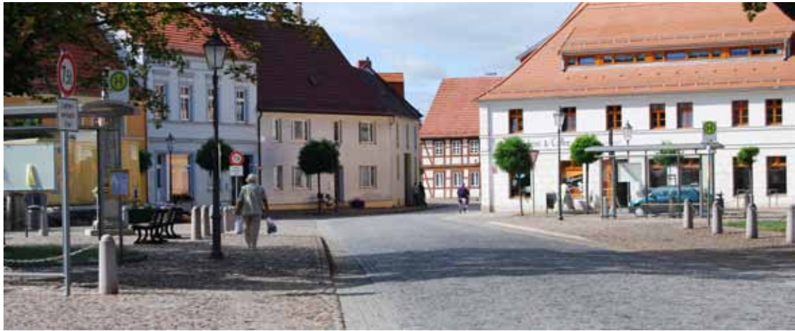
Bild 47: Fahrbahnanhebung im Bereich des Marktplatzes (Uebigau)
