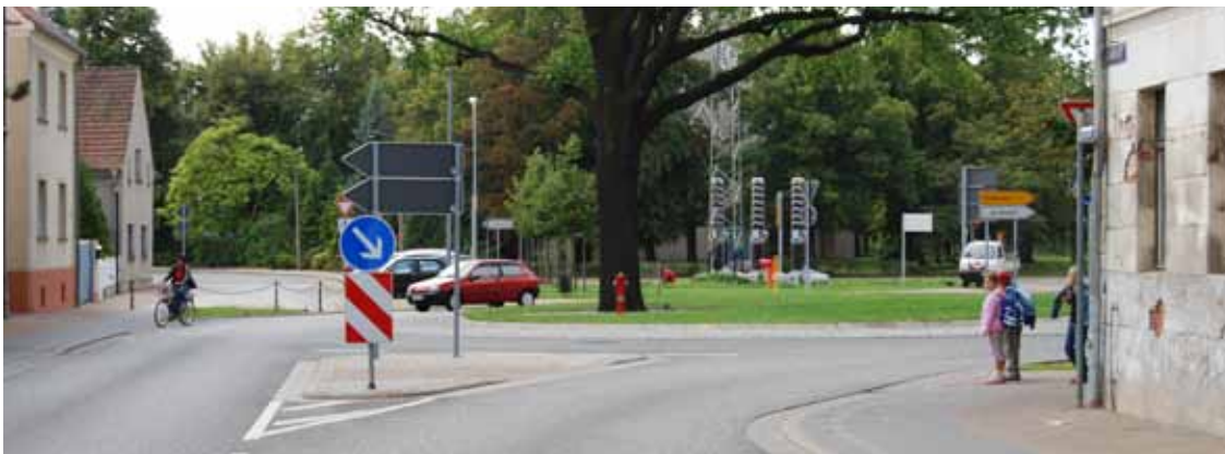
Bild 60: Kleiner Kreisverkehr mit integriertem altem Baumbestand (Falkenberg)
