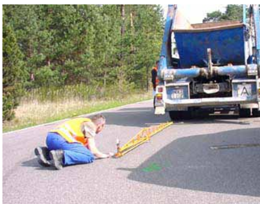
Bild 9: Einsenkungsmessung mit Benkelman-Balken auf flexibler Befestigung
