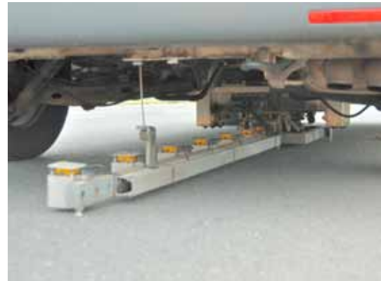
Bild 10: Einsenkungsmessung mit Falling-Weight-Deflectometer (FWD)
