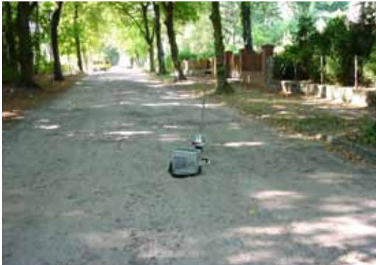
Bild 14: Tragfähigkeitsmessung mit dem Leichten Fallgewichtsgerät auf einer alten sandgeschlämmten Schotterdeckschicht ( E_{vd\ 10\%-Quantil} = 60\text{ MN/m}^2 )
