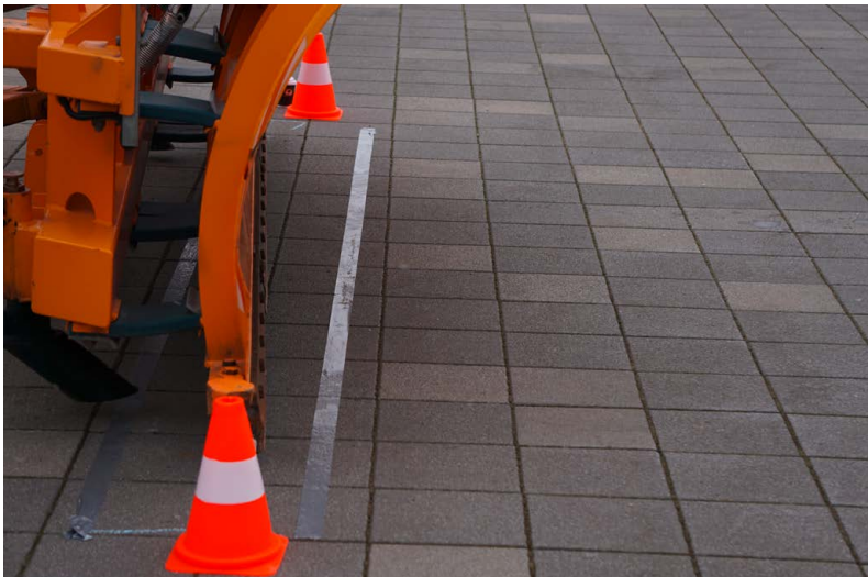
Abb. 6: Abstellen des Fahrzeuges mittig mit der Hinterachse auf einer Linie und das Ablegen des Frontpfluges auf einer Linie
