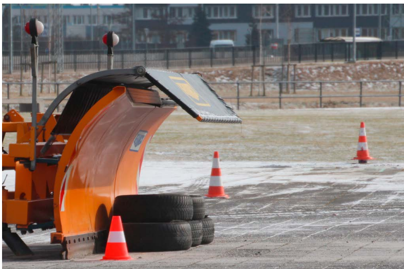
Abb. 3 u. 4: Passgenaues Schieben von Hindernissen (Kegeln und Reifenstapeln) auf Zielpunkte bzw. Linien
