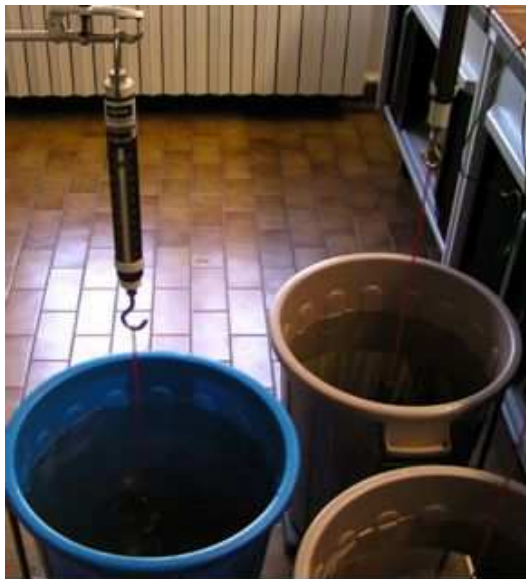
Abbildung 3: Prüfaufbau zur Bestimmung der Auftriebseigenschaften
