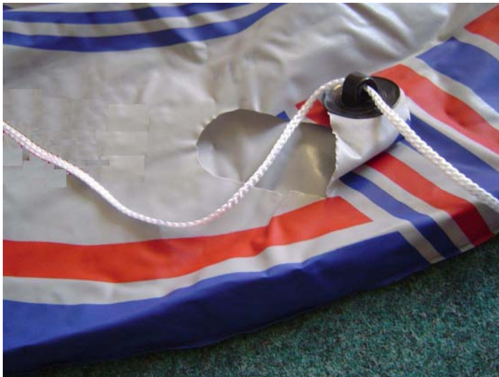
Bild: Halterung zu Aufnahme der Sicherheitsleine ist aus der Bootshaut ausgerissen.
